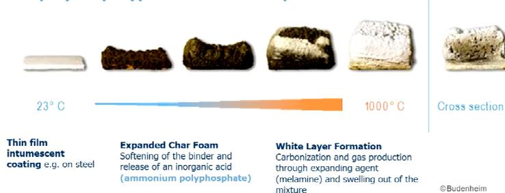
Os polifosfatos de amônio garantem uma espuma estável e protegem as estruturas de aço do colapso. Além disso, a transmissão de oxigênio é impedida e a propagação de vapores tóxicos durante o incêndio é inibida. O uso do *FR CROS®* leva a uma proteção contra incêndio não tóxica e ambientalmente amigável. Esses são fatores importantes para a máxima segurança das pessoas.
